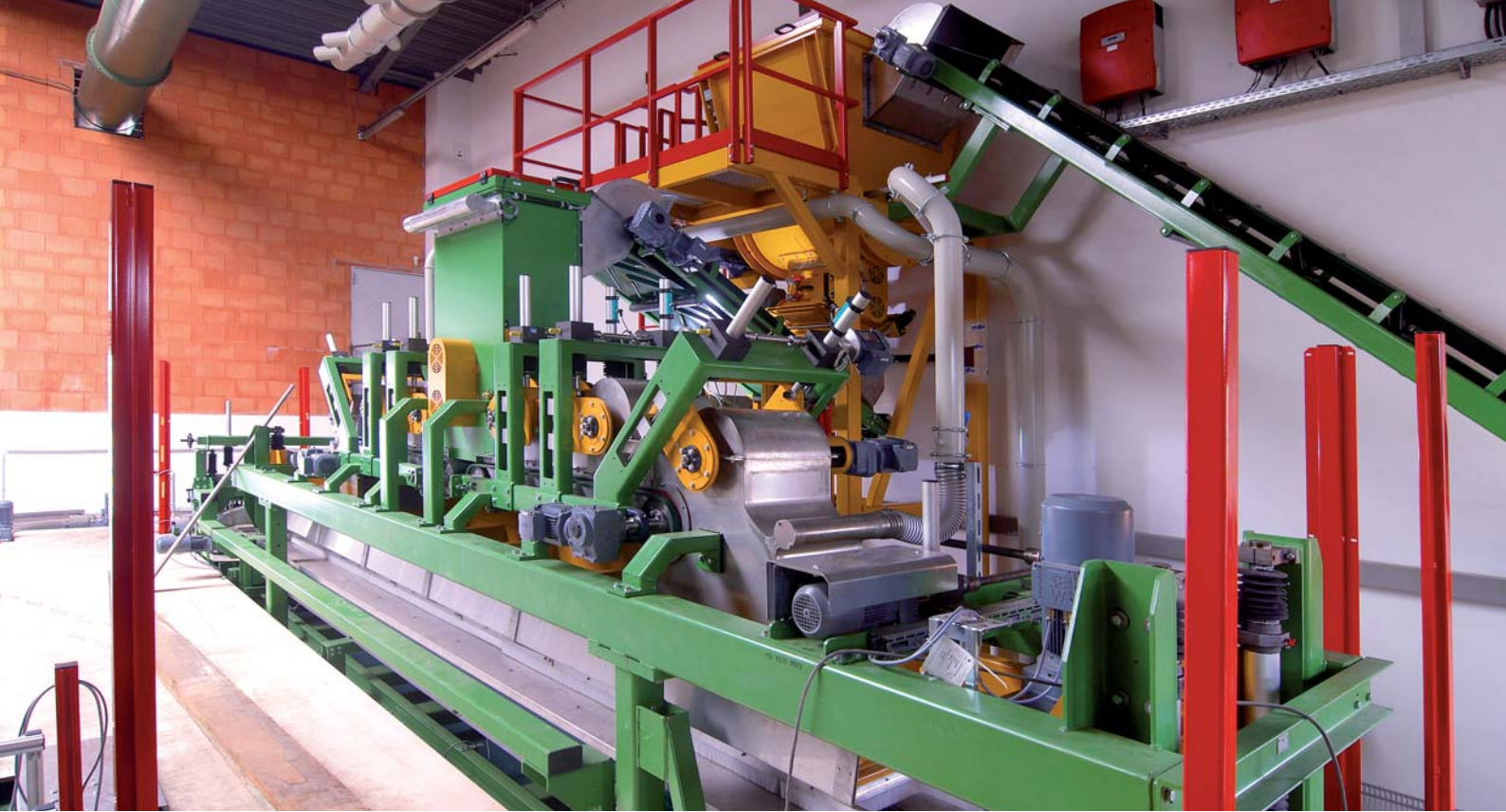
Neue Dämmstoff-Verfüllanlage für ökologische CORISO-Ziegel von Wöhrl
