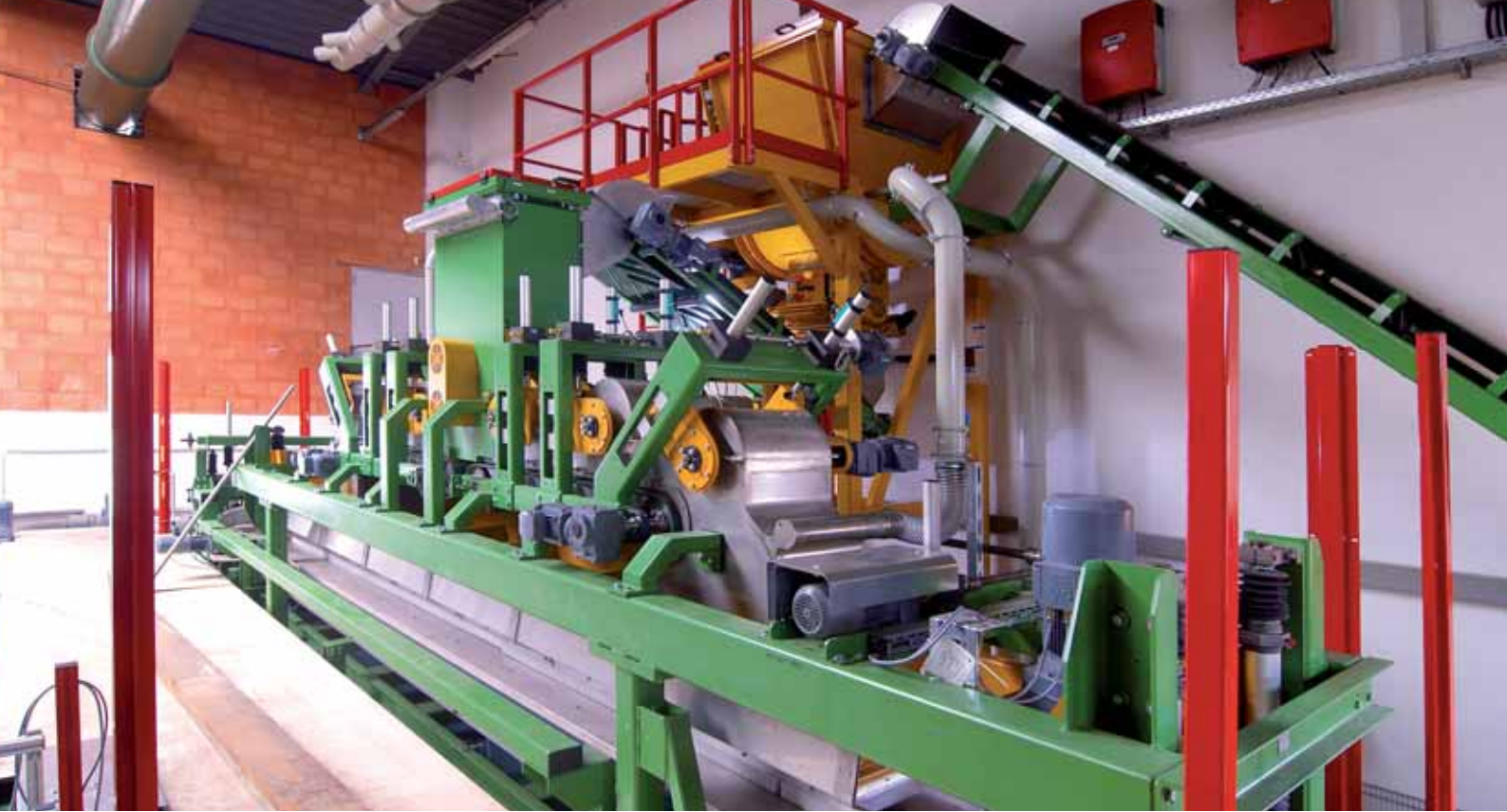
Neue Dämmstoff-Verfüllanlage für ökologische CORISO-Ziegel von Wöhrl
